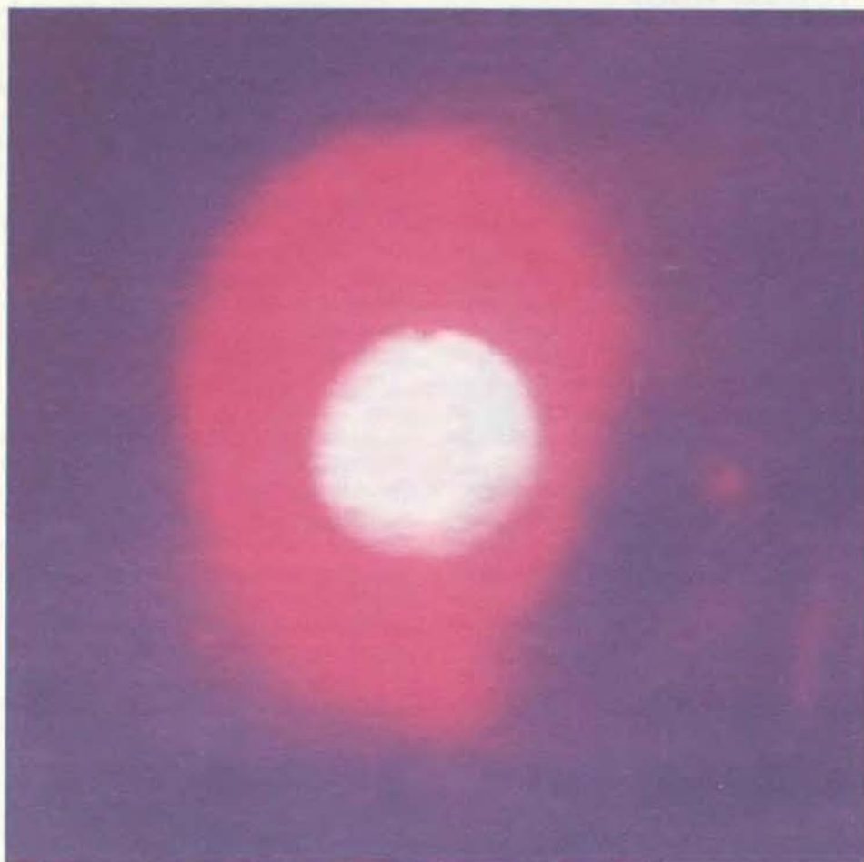
ИЗОБРАЖЕНИЕ ЛАЗЕРНОГО ПЯТНА, заснятое с борта космического корабля многогодового использования «Дискавери» во время проведения эксперимента в июне 1985 г. Луч лазера с вершины горы на Гавайях был послан к отражателю на борту «Дискавери» и удерживался на нем более двух минут. Корабль в это время пролетал над Гавайями на высоте примерно 400 км. При прохождении через атмосферу диаметр луча, первоначально равный диаметру карандаша, увеличился до 457 см.
